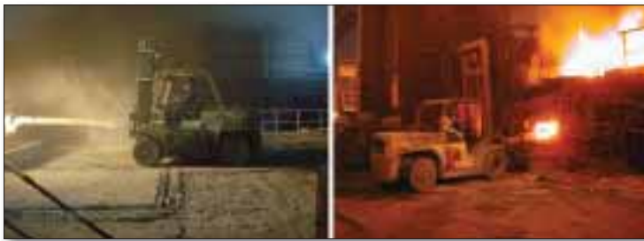
🕒 Fig 1 Slag door clearing operations
